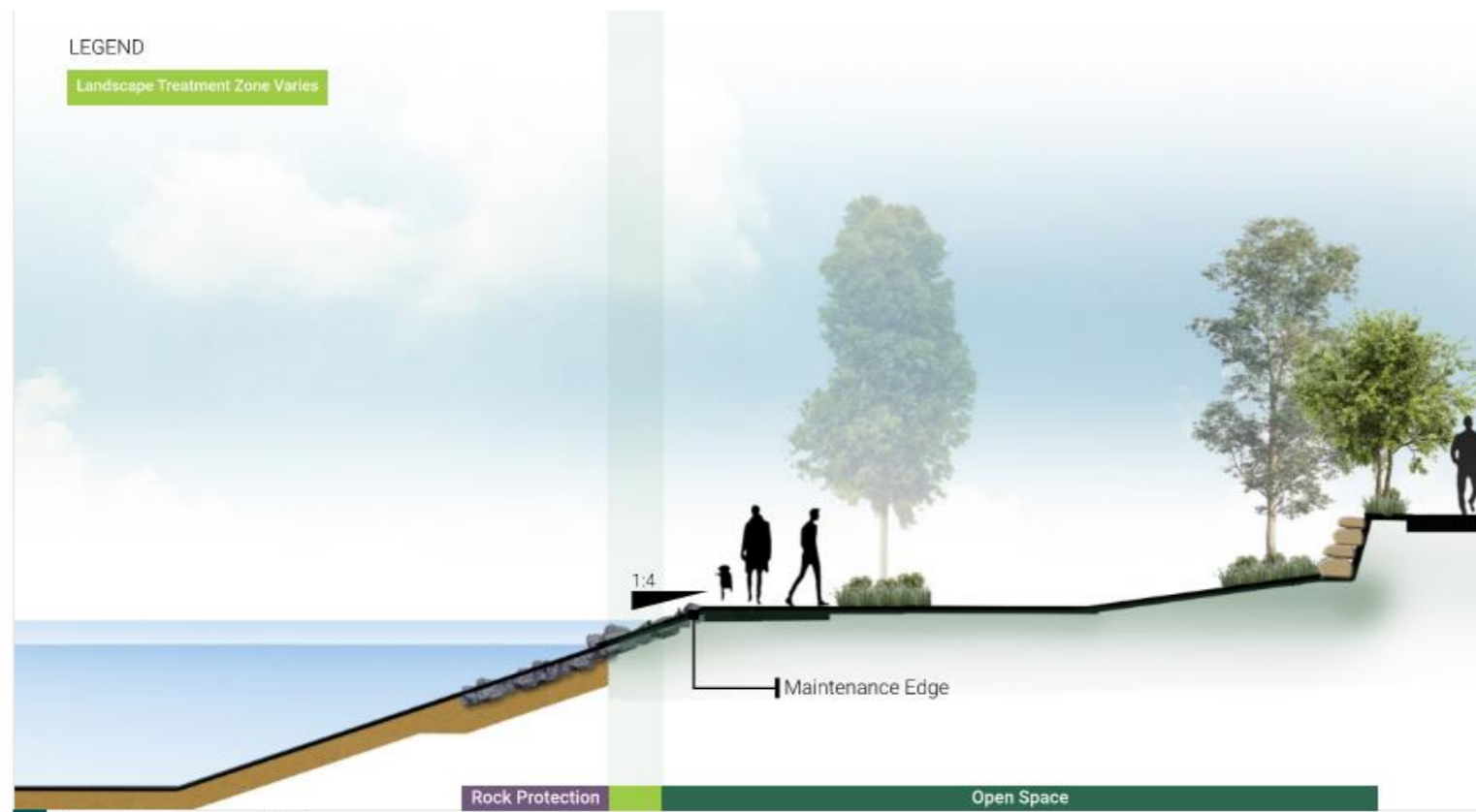
1 Rock Revetment Edge
