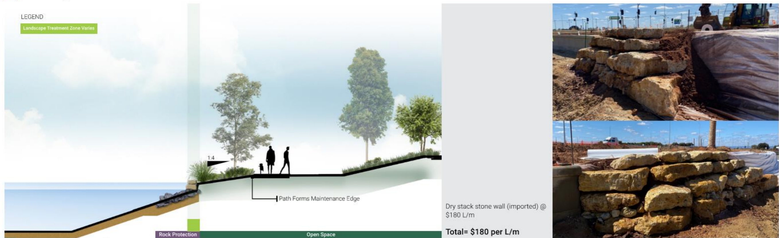
4 Sandstone Revetment Edge
